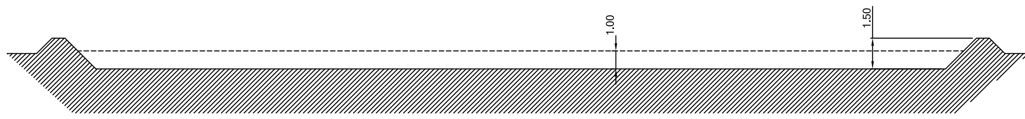
TERRENO NATURAL SECCIÓN Balsa 1
